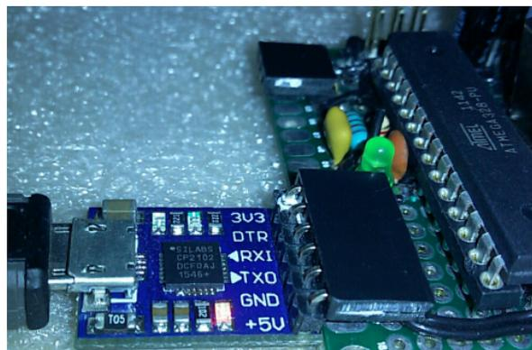
Figura 4.11: Adaptador USB para UART/TTL baseado no CI CP2102
